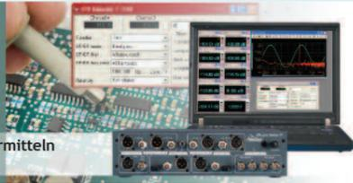
Exklusive, vom Benutzer konfigurierbare flexible Instrumente zur Messung und Überwachung von über 40 verschiedenen Parametern zur gleichen Zeit: Amplitude, THD+N/Klirrfaktor, THD, N, n-te Harmonische, Netzbrummen, Übersprechen, Verstärkung und vieles mehr. Und das alles zur gleichen Zeit.
